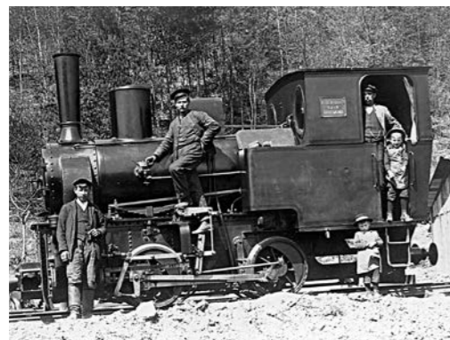
1922 - Dampfloks „Auguste“: Bei größeren Erdbewegungen wurden seit 1908 Schmalspurdampfloks eingesetzt.
